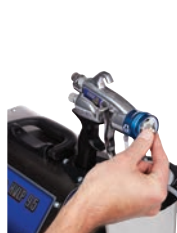
1. Zdemontuj przednią głowicę rozpylającą i dyszę.
