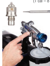
2. Przesuń język spustowy do zwolnienia iglice.
